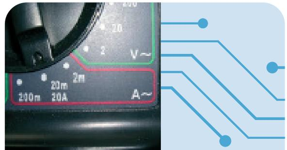
Si nous voyons que la valeur que nous mesurons est **inférieure ou égale à 20 mA**, nous pouvons régler l'appareil de mesure sur 20 mA.
