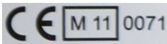
Figuur 26: voorbeeld van de verplichte MID markering op een GSC meter
