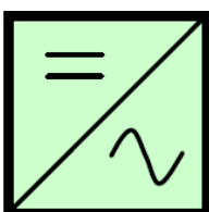
Figuur 49: omvormer zonder galvanische scheiding van het net
