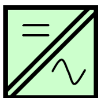
Figuur 50: omvormer met galvanische scheiding van het net
