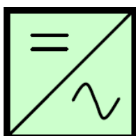
Figure 49 - Onduleur sans séparation galvanique du réseau
