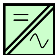
Figure 50 - Onduleur avec séparation galvanique du réseau
