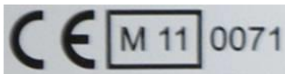
Figure 26 - Exemple de marquage MID obligatoire sur un compteur de CV
