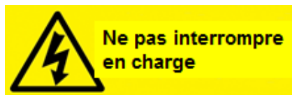
Figure 31 - Exemple pictogramme indiquant que la coupure en charge est interdite
