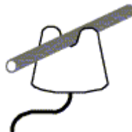
Figuur 5.24. Plaatsingswijzen van elektrische leidingen – Op isolatoren
