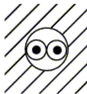
Figuur 5.22. Plaatsingswijzen van elektrische leidingen – Rechtstreeks verzonken, zonder buizen
