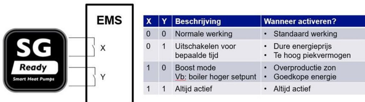
Figuur 5: Smart grid Ready contacten
