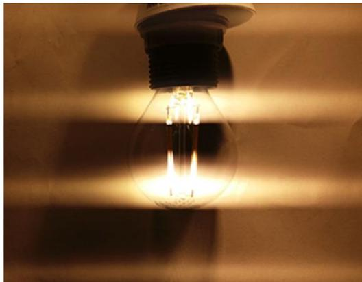
Un circuit électronique de haute qualité peut réduire à presque zéro le scintillement des lampes LEDs à gradation. Cependant, cela implique un effort matériel et donc des coûts. Par conséquent, nous pouvons supposer que dans la plupart des produits bon marché, aucun ballast électronique ne soit installé ou seulement un ballast électronique inadéquat .
