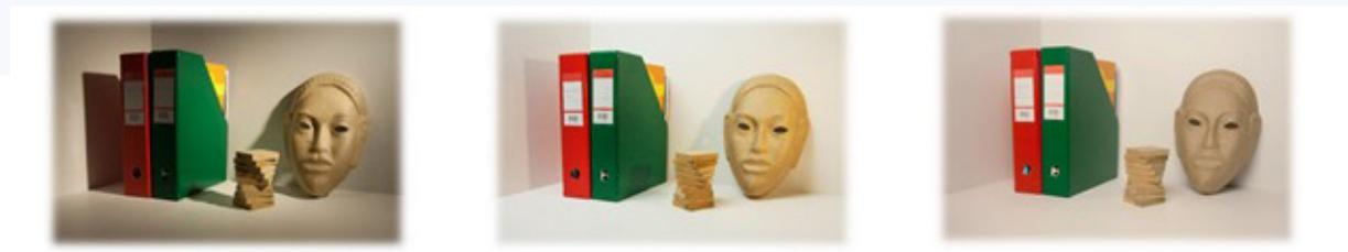
La norme utilise l'éclairage cylindrique moyen,  $\bar{E}_z$ , comme indicateur pour ce critère. L'éclairage cylindrique est la quantité de lumière incidente sur une petite surface cylindrique en un point par unité de surface. Sa valeur peut être estimée en prenant la moyenne des éclairages verticaux mesuré ou calculé dans les quatre principales directions orthogonales en un point donné.
