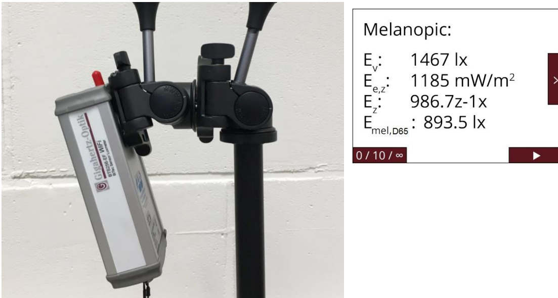
Figure 9. Photospectromètre, incliné à 15°.
