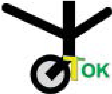
Figuur 44: Blokkeren wielen rolsteiger
