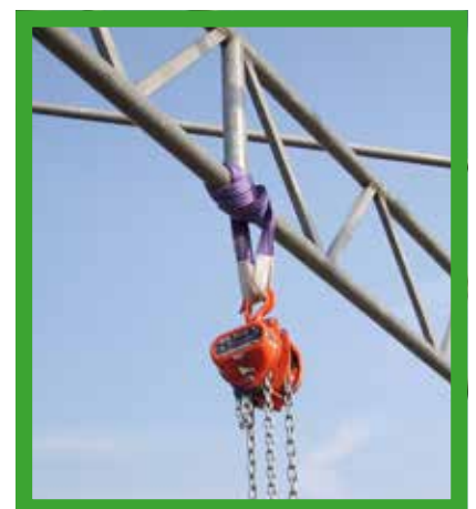
Figuur 33: De positie van de takel is OK (zolang de fabrikant van de leng deze toepassing accepteert).
